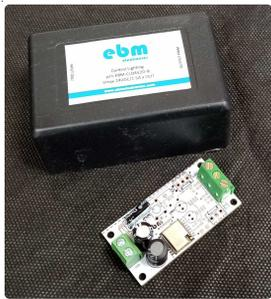
Controladora ebm DALI/DMX, utilizada para el control de drivers de iluminación, luminarias, cinta LED.
