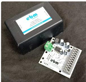
Controladora ebm DALI/DMX, utilizada para el control de drivers de iluminación, luminarias, cinta LED.
