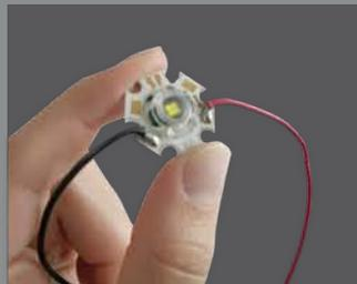
LED (Diodo Emisor de Luz) de 3 Voltios cada uno y un consumo mínimo de energía de 100 vatios total; montados sobre aluminio inyectado para asegurar su disipación de temperatura y larga vida útil de 30.000 horas mínimo, pueden ser reemplazados de forma individual.
